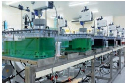
車載用リチウムイオン電池からバッテリーグレード金属塩を回収する実証試験装置（日立事業所）
